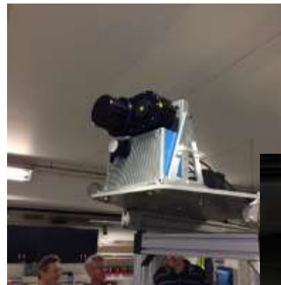
Fordonsburet system för vägytemätning (ViaTech ViaPPS IRI+)
