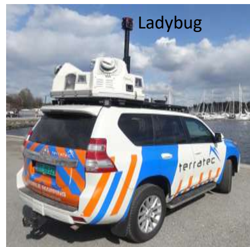
Fordonsburet system för datainsamling väg/järnväg
