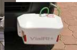
Fordonsburet system för vägytemätning (ViaTech ViaPPS IRI+)
