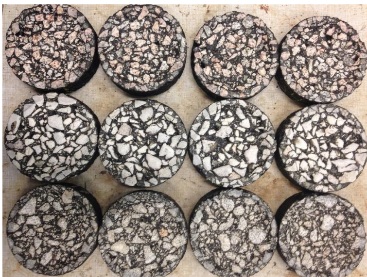
Figur 8. Fotografier på provkroppar efter körning från ett laboratorium. (Material 1, prk 1-4, i övre raden, Material 2 och 3 i rad 2 och 3).
