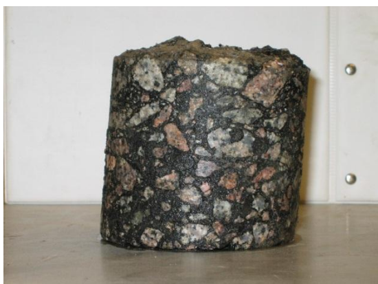
Figur 2 Exempel på sneda borrprov
