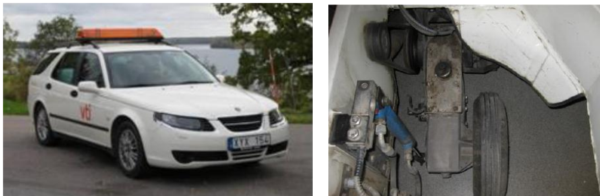
Figur 15. VTIs friktionsmätbil med det bromsade mät hjulet placerat under bilen
