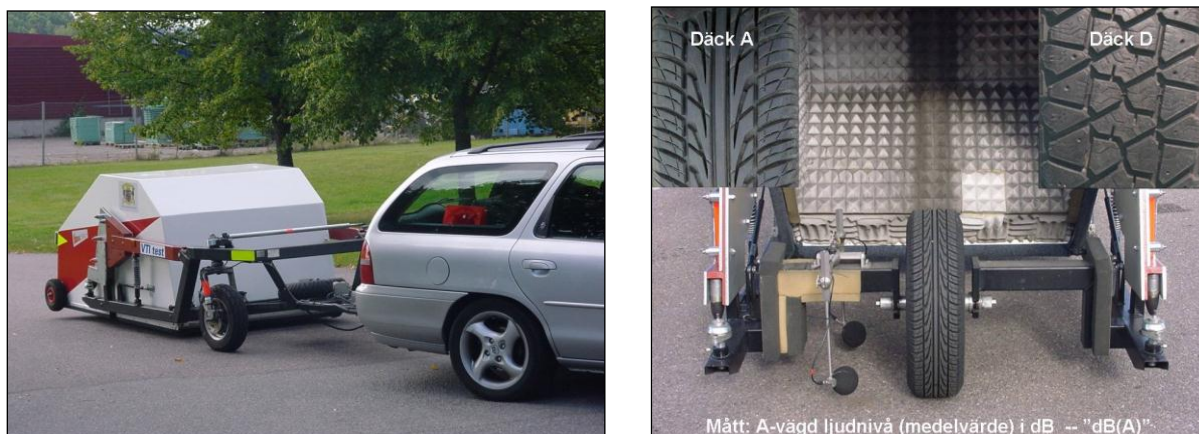
Figur 12. Mätvagn för bullermätning i stängt läge (mätning) och i öppet läge.
