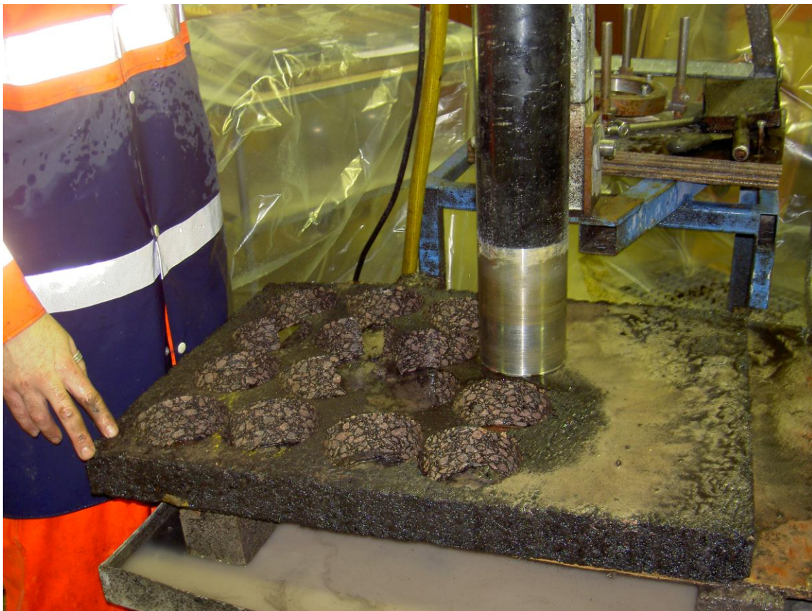
Figur 4. Borrning av provkroppar ur plattor
