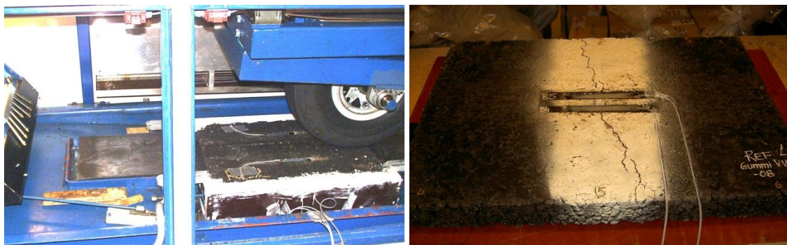
Figur 5. Sprickutbredningstest i VTIs WTT utrustning.
