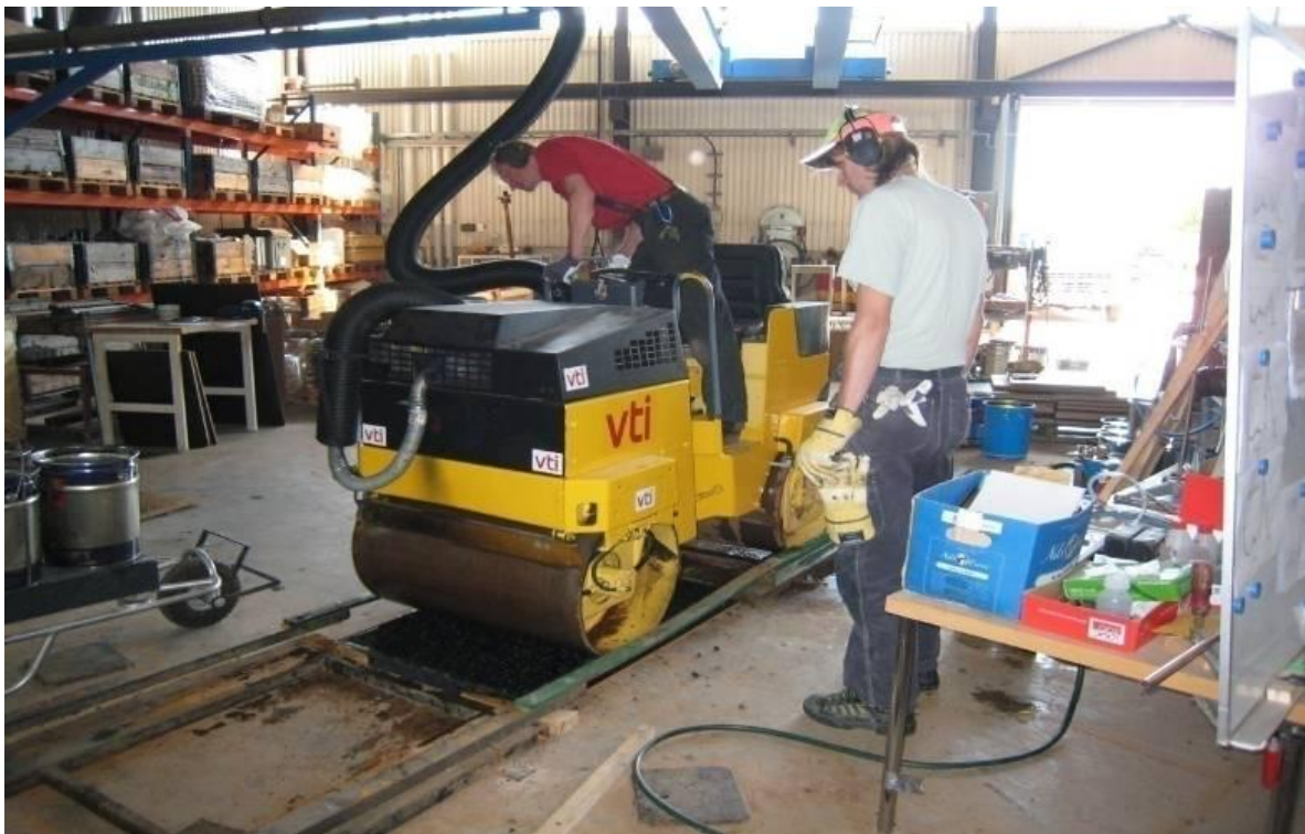
Figur 3. Tillverkning av provplattor
