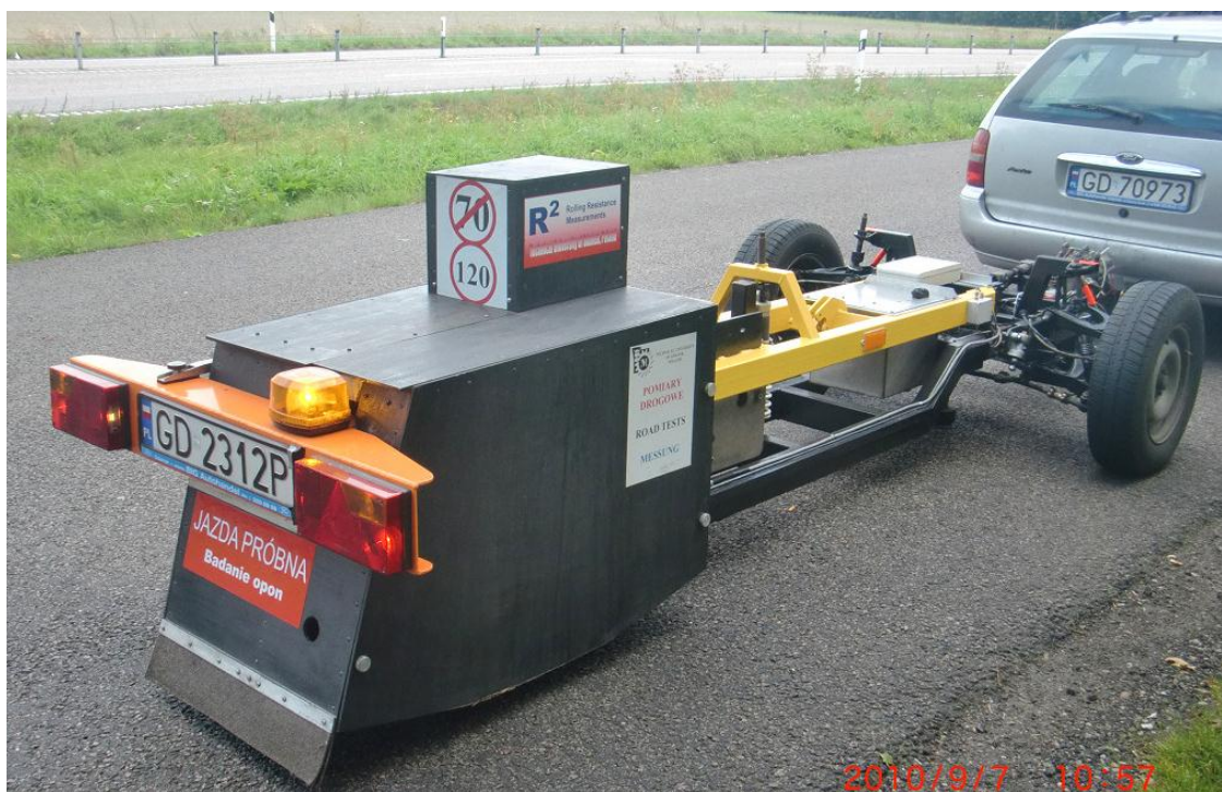
Figur 13. Trailer för mätning av rullmotstånd från TUG. Foto från TUG.
