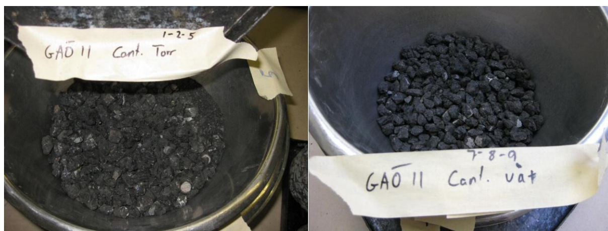
Figur 9. Totalt sönderfall i LA trumma vid misslyckad packning av GAÖ 11 massa.
