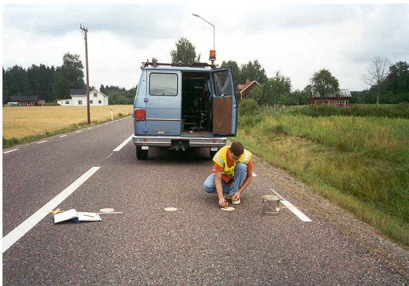
Figur 2 Mätning av textur med hjälp av sandutfyllnadsmetoden, MTD.
