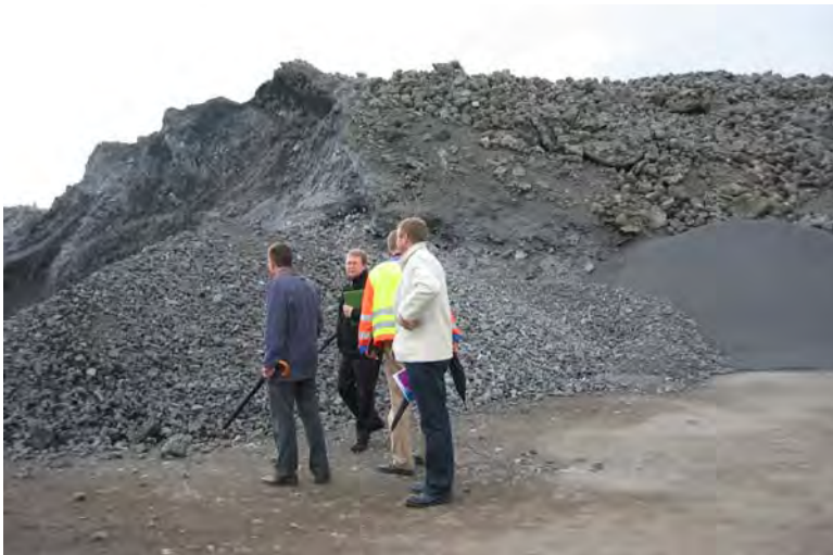
Bild 1 Upplag av stålslagg (råslag) från ett stålverk i Danmark med relativt högt innehåll av metallskrot.
