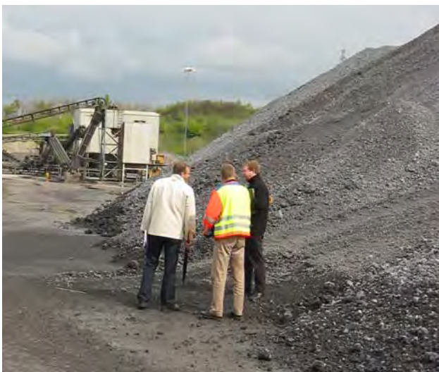
Bild 2 Upplag av stålslagg, 0–120 mm, från Smedjebacken, med relativt lågt innehåll av metallskrot.
