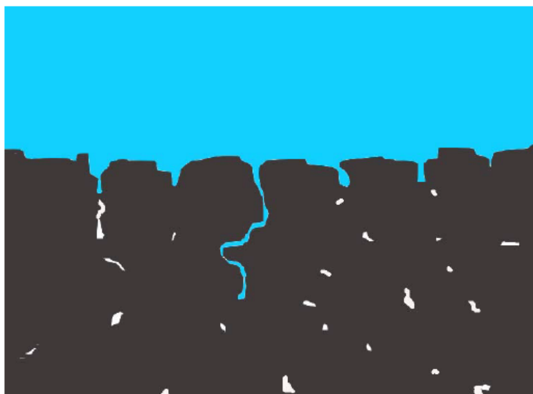
Figur 1. Skrymvolym enligt vattenmetod A definieras av det vatten (blått i figuren) som omsluter och tränger in i provkroppen
