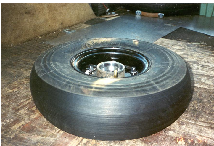
Bild 3 Truckdäck (9 tum, ringtryck normalt 0,8 MPa) för stabilitetsförsök i PVM.
