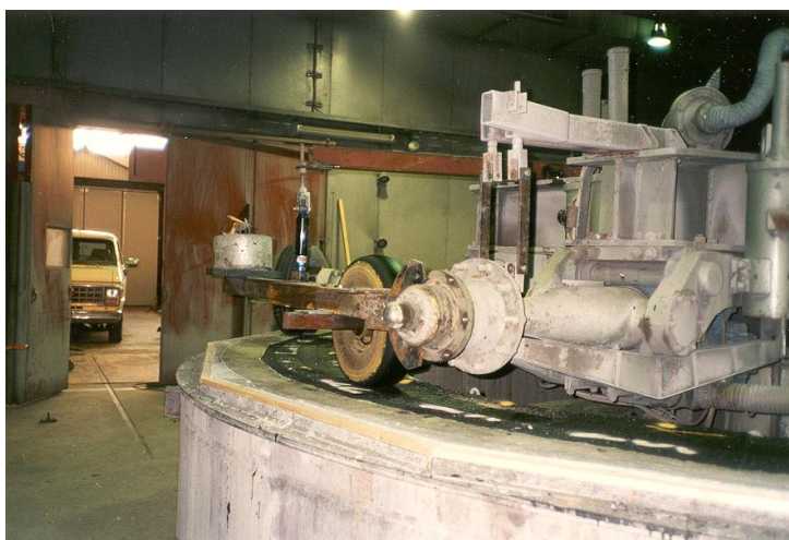
Bild 2 Belastningsanordning (pångsvagn) för stabilitetsförsök i PVM.
