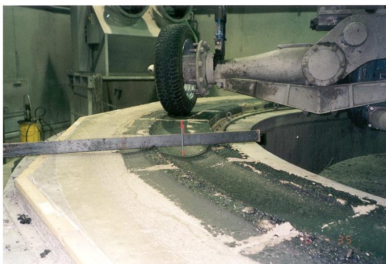
Bild 4 Exempel på spårbildning (plastiska deformationer).
